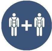
Nombre de personnes pouvant utiliser simultanément le système de protection antichute: Le système antichute peut être utilisé par deux personnes en même temps, mais la chute ne doit pas se produire en même temps.
