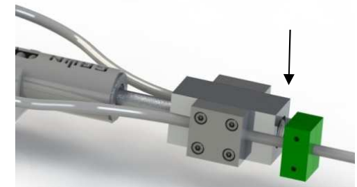
Abb. 3: Nach Systembelastung: Die Klemme hat einen Abstand > 5mm. Eine Systemkontrolle ist zwingend notwendig!
