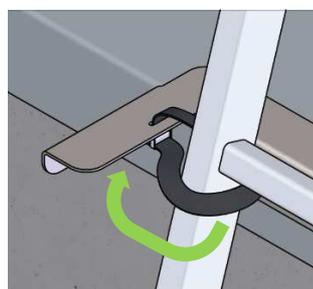
Sécuriser l'échelle avec la courroie de fixation fournie sur l'une des deux fentes prévues à cet effet dans le porte-échelle.
