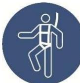
L'utilisation d'un équipement de protection individuelle contre les chutes est requise lors de l'utilisation du système (selon PSAGA EN 361 et EN 363 avec absorbeur d'énergie ainsi que les forces agissantes doivent être réduites à moins de 6 kN). Les instructions du fabricant de l'équipement utilisé doivent être respectées.
