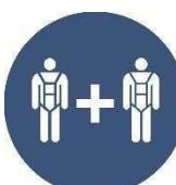
Nombre de personnes pouvant utiliser simultanément le système de protection antichute: Le système antichute peut être utilisé par deux personnes en même temps, mais la chute ne doit pas se produire en même temps.
