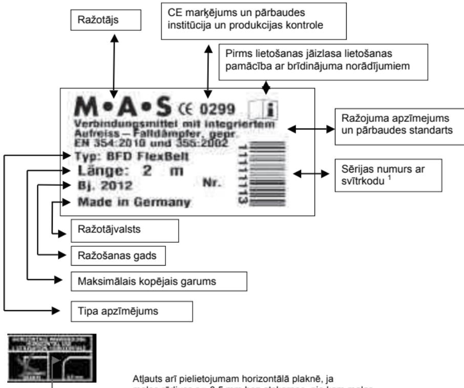
Atļauts arī pielietojumam horizontālā plaknē, ja malas rādiuss  $r = 0,5$  mm bez atskarpes, pie kam malas konstrukcijas leņķim jābūt vismaz  $90^\circ$  grādiem.
