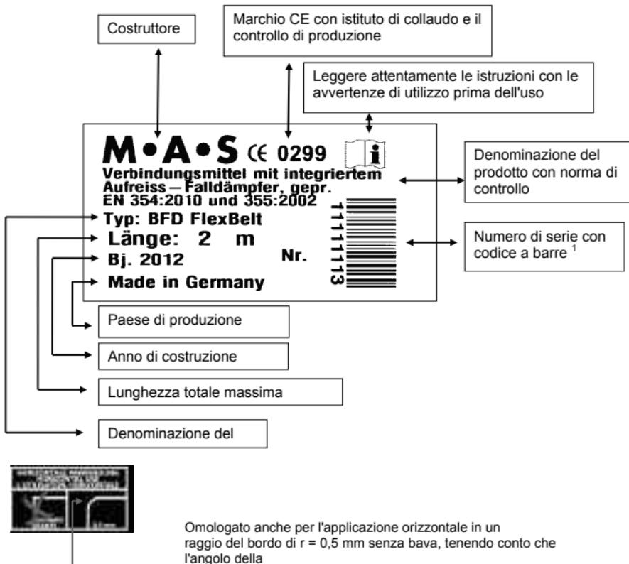
Omologato anche per l'applicazione orizzontale in un raggio del bordo di  $r = 0,5$  mm senza bava, tenendo conto che l'angolo della realizzazione del bordo deve corrispondere almeno a  $90^\circ$ . (si veda anche al punto 3.2)
