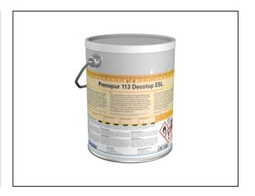
Applizieren: Prenopur 113 Decotop ESL wird mit einer geeigneten Rolle oder Pinsel appliziert. Als Faustformel sollten ca. 2/3 des Harzes unter dem Vlies und 1/3 über dem Vlies "nass in nass" appliziert werden. Vliesüberlappungen sind mindestens 5 cm breit. Prenopur 113 Decotop ESL sollte nicht mehr als 5 - 10 mm über das Vlies hinaus aufgetragen werden.
