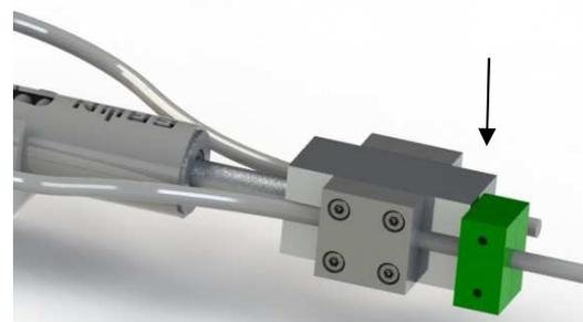
Fig. 2: Controllo visivo del morsetto indicatore
