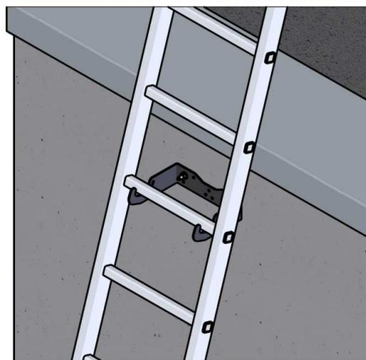
Fixer le porte-échelle avec un matériel de fixation adapté sur le mur/la façade.
