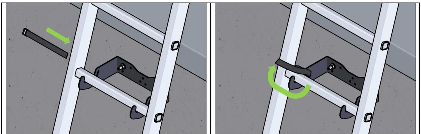
Sécuriser l'échelle avec la courroie de fixation fournie sur l'une des deux fentes prévues à cet effet dans le porte-échelle.
