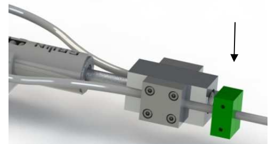
Ill. 3 : Après charge du système : Le bloc a un écartement > 5mm. Un contrôle du système est impérativement nécessaire !
