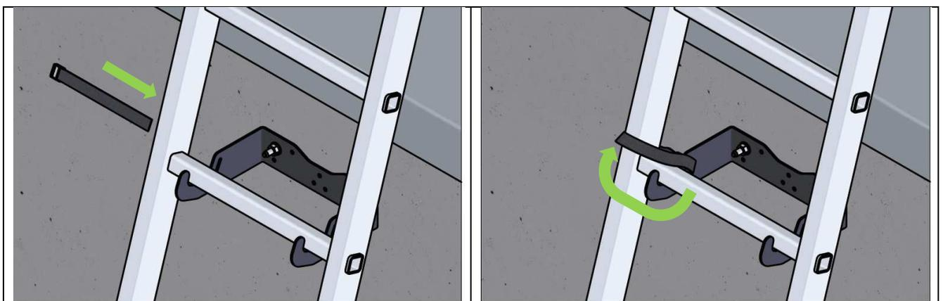
Fissare la scala con le cinghie di fissaggio (incluse nella fornitura) a una delle due fessure previste nel supporto scala.
