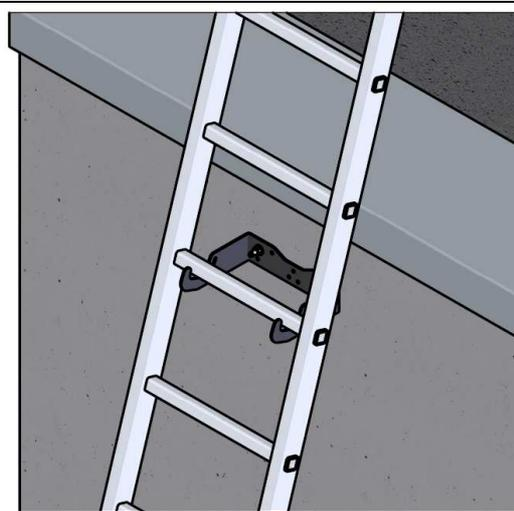
Fissare il supporto scala alla parete/facciata con il materiale di fissaggio adatto.
